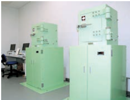
写真4-95 放射線健康管理センターの機器 水道水、井戸水、食品などを検査するゲルマニウム半導体検出器。 [平成24(2012)年6月 いわき市撮影]
